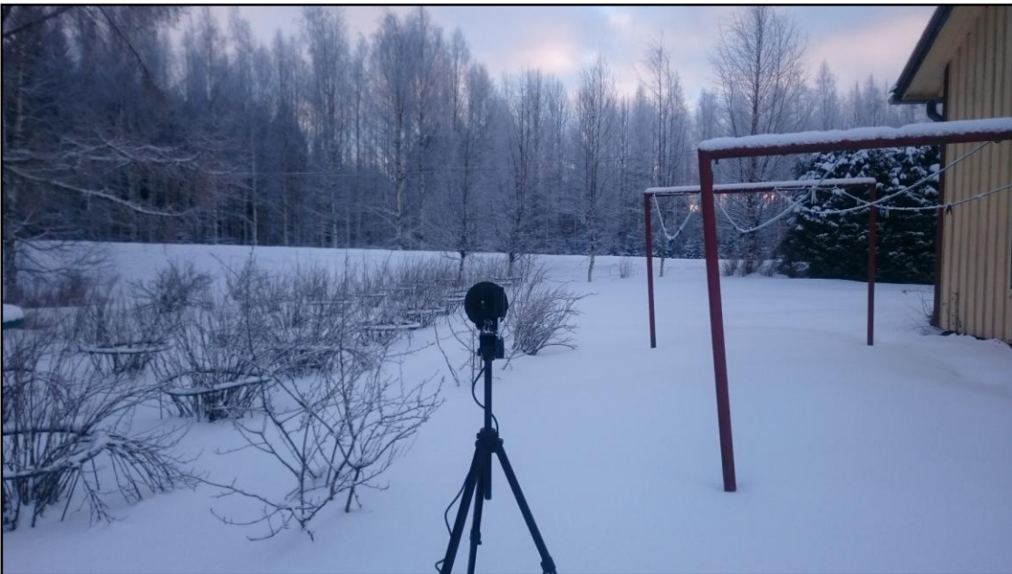
Kuva 4 Mittauspiste MP2. Louhinnan porausvaiheen äänitasomittaus 17.1.2017 Tervakallion kallioalueella. Porausvaunu sijaitsee melumittarin mikrofonin osoittamassa suunnassa.
