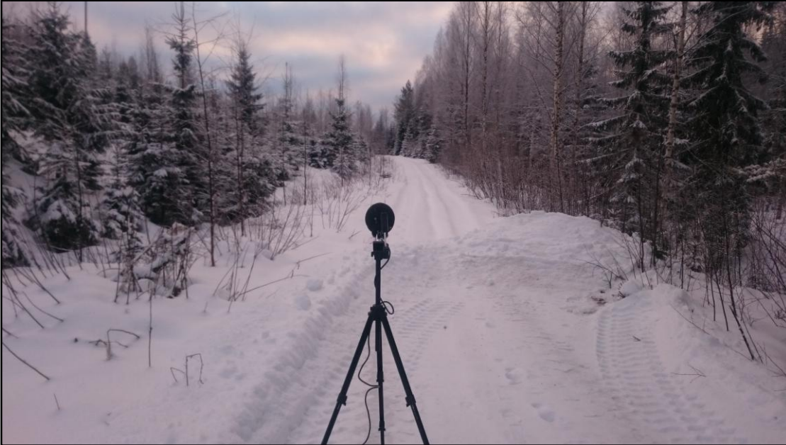
Kuva 5 Mittauspiste MP3. Louhinnan porausvaiheen äänitasomittaus 17.1.2017 Tervakallion kallioalueella. Porausvaunu sijaitsee melumittarin mikrofonin osoittamassa suunnassa.
