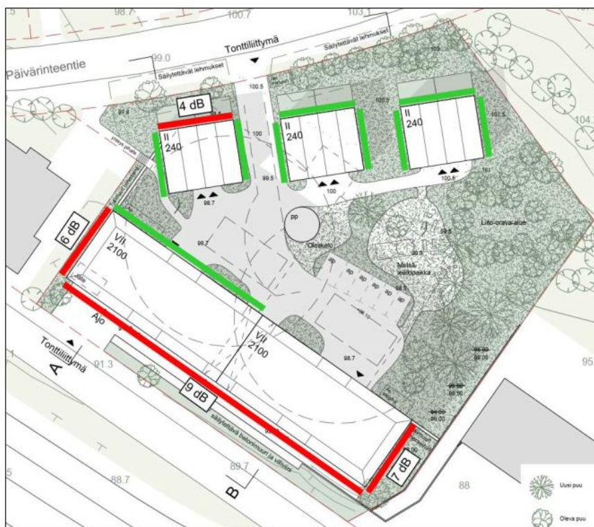
Kuva 29. Suositukset lasitettujen parvekkeiden äänitasoerovaatimuksiksi \Delta LA , vaad. Vihreällä on esitetty julkisivuilla sijaitsevat parvekkeet, jotka suositellaan lasitettavaksi, mutta niiden meluntorjuntaa ei ole tarpeen erikseen mitoitaa. Kuva selvityksestä Puutarhakatu 4, Kuopio, Liikennemeluselvitys, A-insinöörit, 1.6.2026 .
