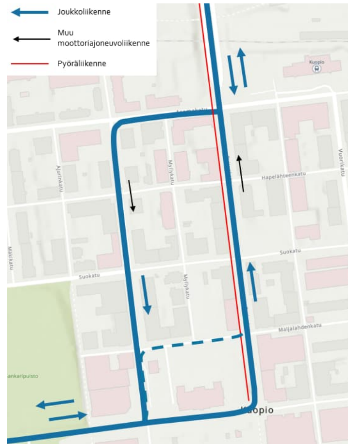
Kuva 22. Puijonkadun liikenneverkollinen rooli vaihtoehdossa 2, jossa Puijonkatu yksisuuntainen pohjoiseen. Sininen kuvaa joukkoliikenteen reittejä, musta muuta moottoriajoneuvoliikennettä ja punainen pyöräliikennettä.
