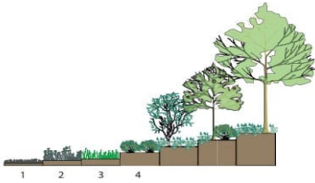
Kuva 6. Viherkattotyypien 1–4 kasvualustapaksuudet: 1. maksaruohokatto 60...200 mm 2. niitty/ketokatto 150...200 mm 3. heinäkatto 200...300 mm 4. kattopuutarha 200...1000 mm kasvialijakohtaisten vaatimusten mukaan
