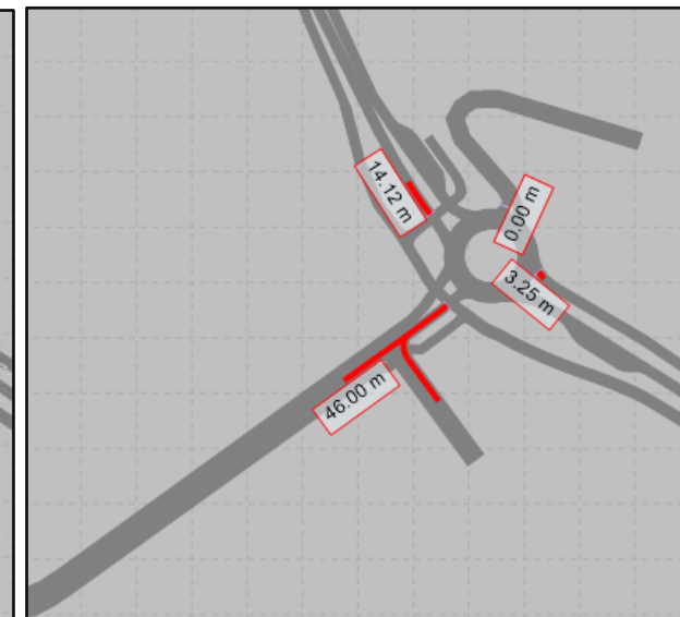
Ve6: Siikaranta valo-ohjattu, ramppi valo-ohjattu, läpiajo sallittu
