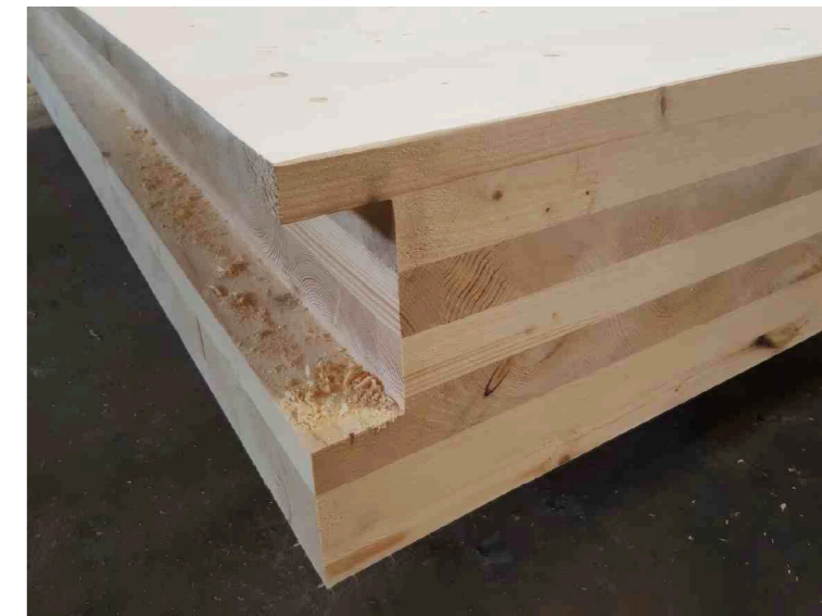
Kuva 6. CLT koostuu kerroksista.
