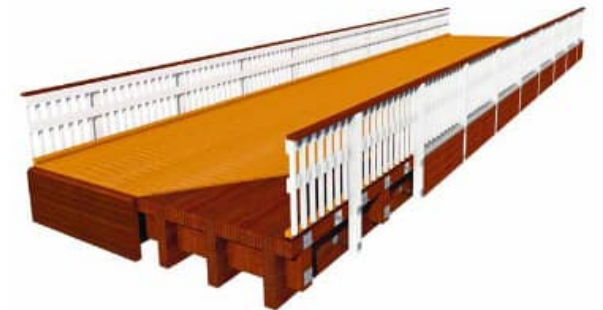
Kuva 46. Esimerkki puurakenteisesta jalankulku- ja pyöräliikenteen sillasta. Lähde: Versowood
