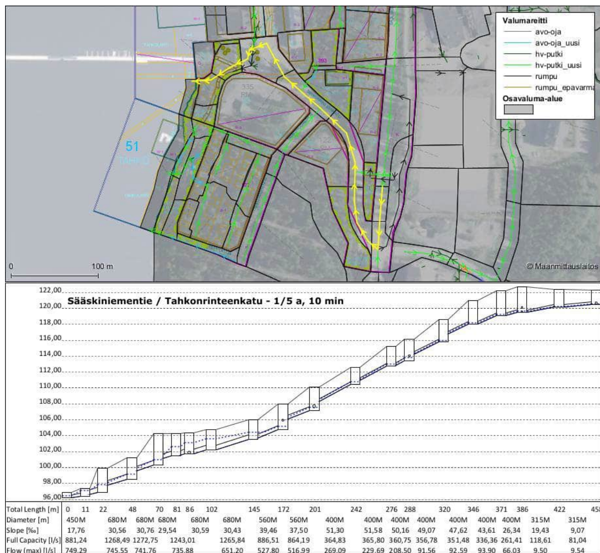
Kuva 27. Pituusleikkaus suunnitellusta hulevesirunkolinjasta Sääskiniementien alapuolella sekä Tahkonrinteenkadulla (Tahkon keskusta) 10 min 1/5 a sateella.
