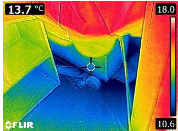
Kuva 7. Lepotilan 116 kaapin ja ulkoseinän liittämipinnat ovat viileät (ilma- ja lämpövuotoja).
