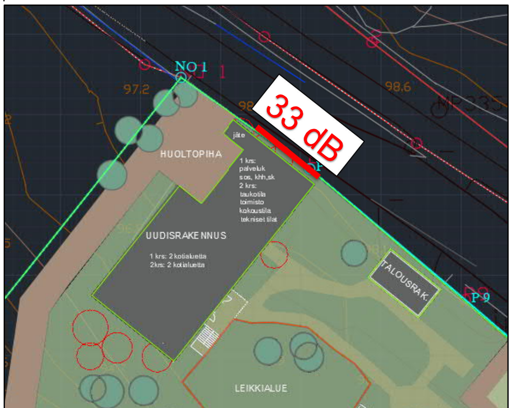
Kuva 5. Suositukset julkisivuille muodostuvista äänitasoerovaatimuksista \Delta L_{A,vaad} .
