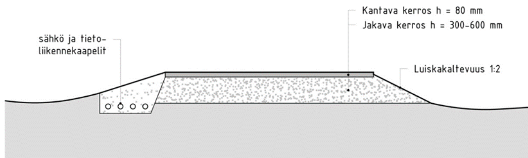
Periaatekuva uuden ja perusparannettavan tien rakenteesta.
