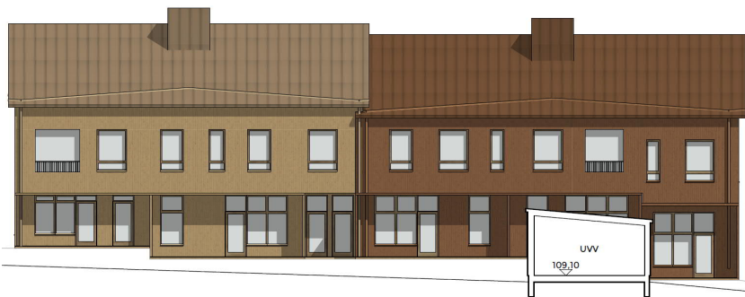
Kuva 4 Julkisivulaudoituksen periaatteita. Kuva OOPEAA:n laatimasta, 28.3.2023 päivätystä luonnoksesta.
