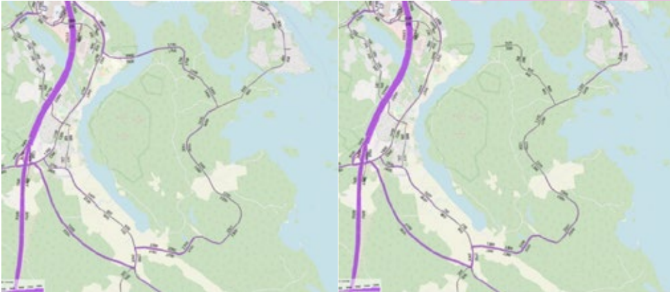
Kuva 4. Autoliikenteen liikennemäärän jakautuminen, kun Koiraveden silta kaikille kulkumuodoille (vasemmalla) ja vain kestäville kulkumuodoille jk, pp ja joukkoliikenne (oikealla).
