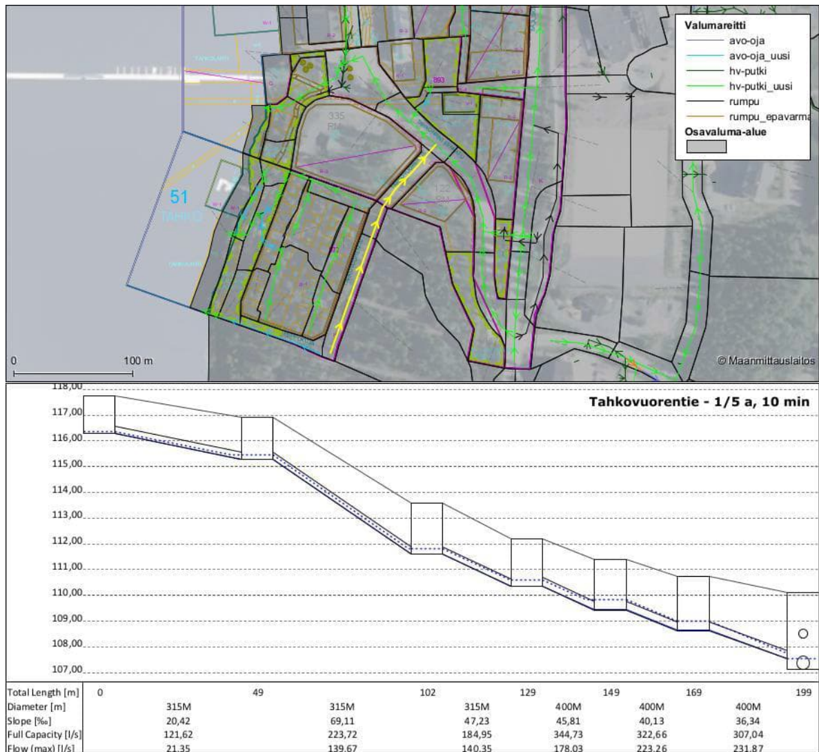
Kuva 32. Pituusleikkaus suunnittelusta hulevesirunkolinjasta Tahkovoorentiellä 10 min 1/5 a sateella.
