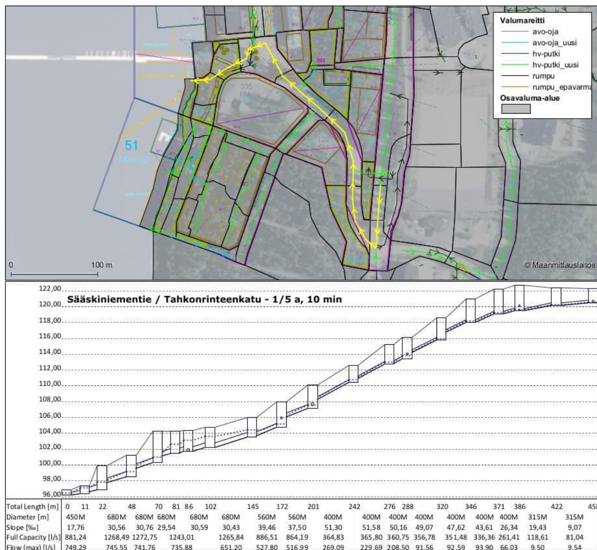
Kuva 27. Pituusleikkaus suunnitellusta hulevesirunkolinjasta Säskiniementien alapuolella sekä Tahkonrinteenkadulla (Tahkon keskusta) 10 min 1/5 a sateella.
