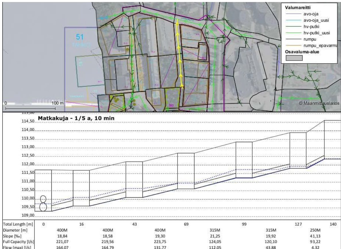
Kuva 31. Pituusleikkaus suunnitellusta hulevesirunkolinjasta Matkakujalla (Tahkon keskusta) 10 min 1/5 a sateella.
